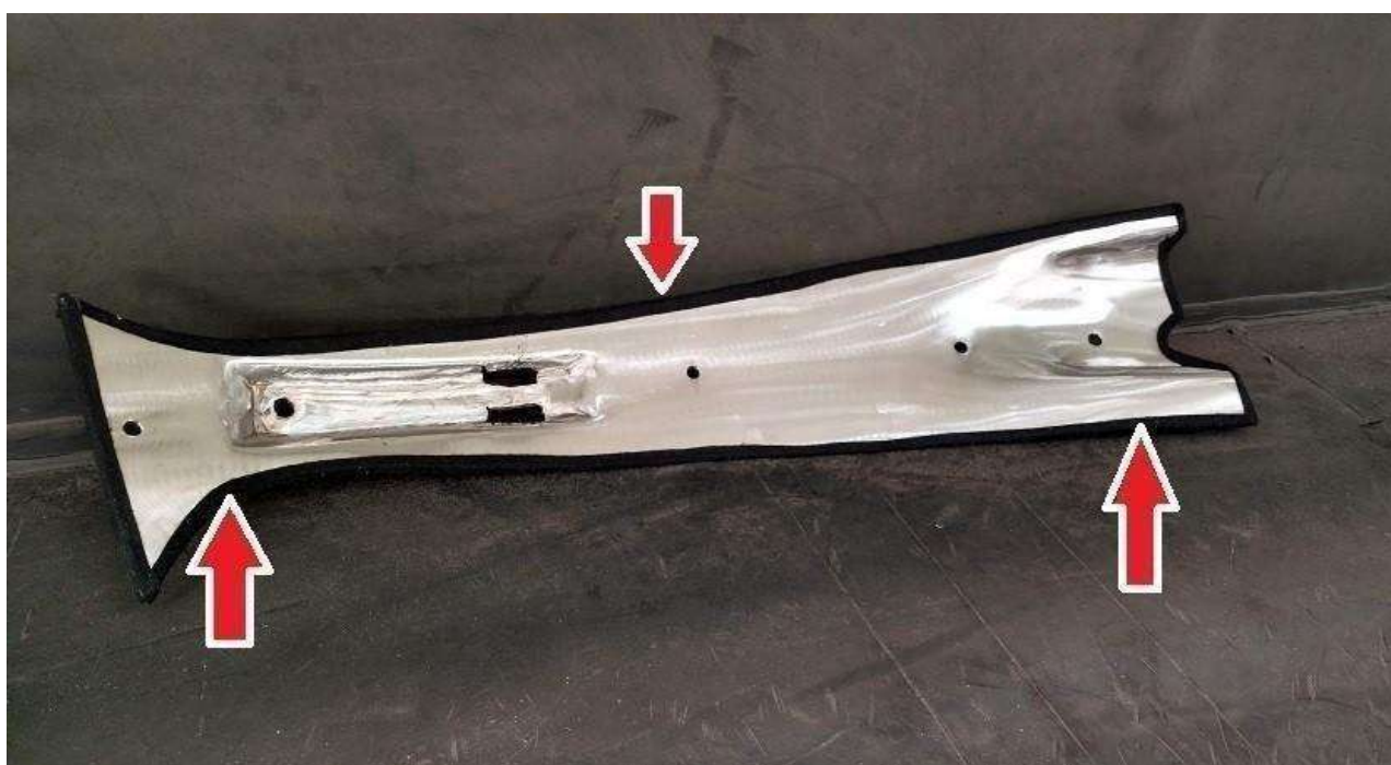
Figura 3 - Detalhe da aplicação da fita feltro nas bordas das chapas de aço
