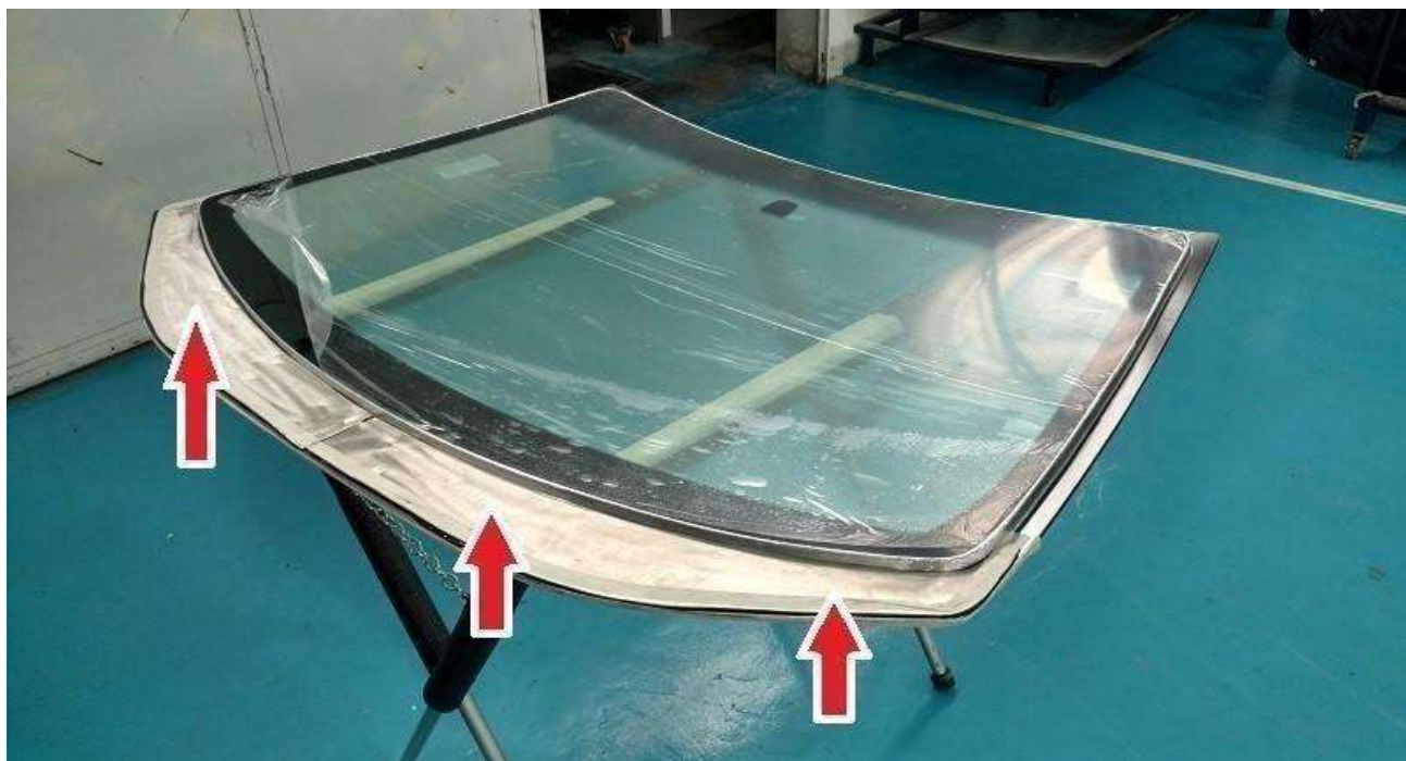
Figura 5 - Reforço em aço inox na região do offset (sorriso) do para-brisa
