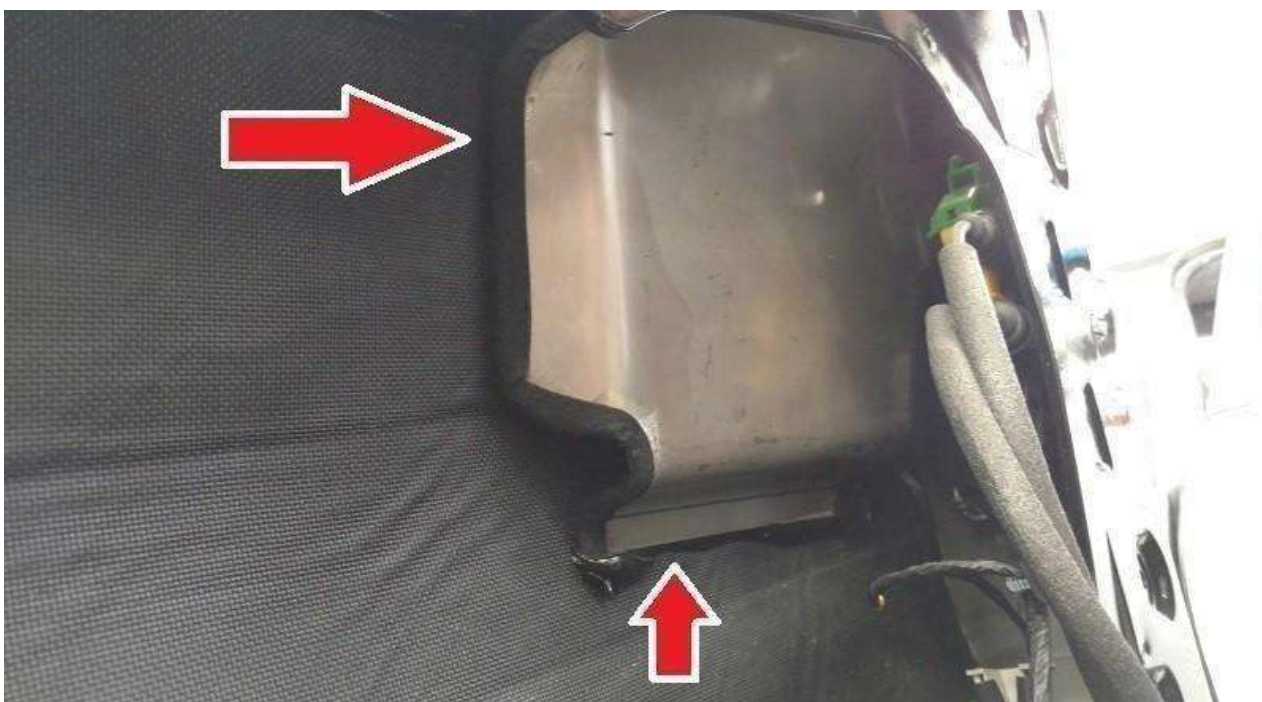
Figura 12 - Detalhe do reforço em chapa de aço inox na região da maçaneta
