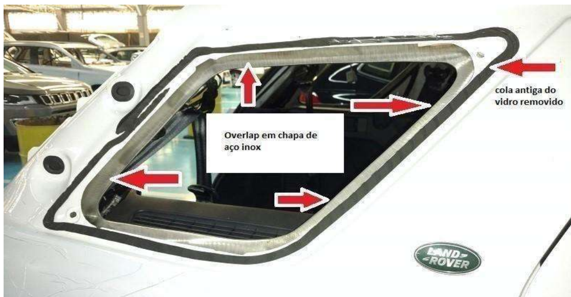
Figura 2 - Exemplo de overlap nos quadros dos vidros fixos
