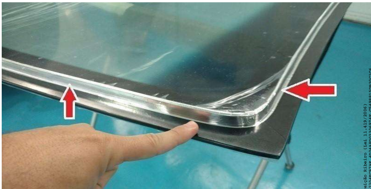
Figura 8 - Fita de alumínio aplicada à lateral do pacote de forma a evitar a contaminação das lâminas
