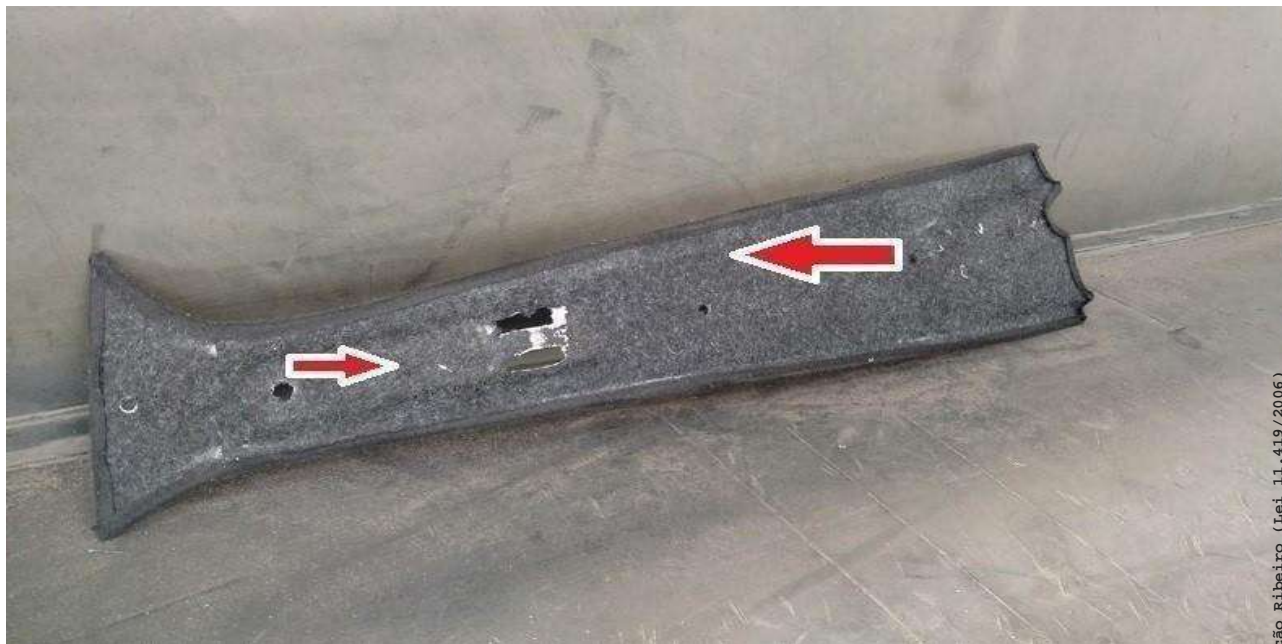
Figura 4 - Detalhe do carpete aplicado na face oposta da chapa de aço
