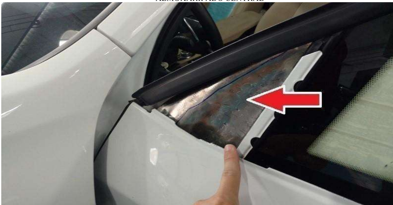
Figura 11 - Chapa de aço inox aplicada na região do retrovisor externo
